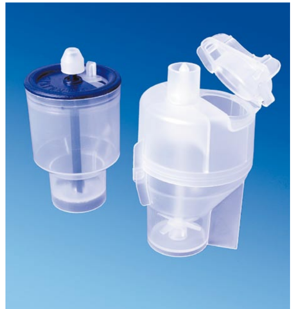
Mischbehälter von Prionics: Dank einer drastischen Vereinfachung der Systemarchitektur konnte die Anzahl der Bauteile von acht (links) auf drei (rechts) reduziert werden. Die Herstellkosten sind 50 % tiefer. (Bilder: zvg)
